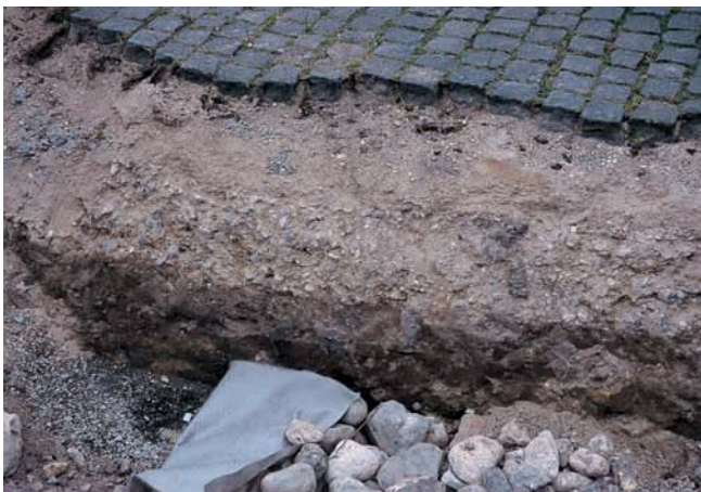
Fig 5 - Il profilo di un tipico suolo urbano di riporto è caratterizzato dall’assenza di orizzonti. Fig 5 - Urban soil typical profile show the complete absence of horizons.
