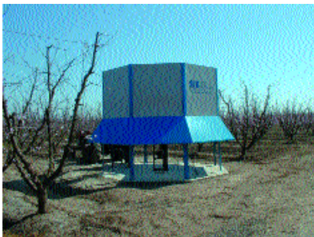
Fig. 4 - Ventilatore ad asse verticale utilizzato per sollevare l'aria fredda stratificata in prossimità del suolo.
